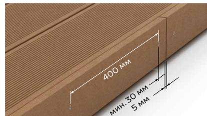
5. Между краем и креплением шурупа, должно оставаться расстояние 30 мм.
